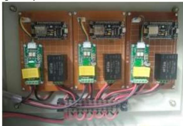
Gambar 5. Implementasi rangkaian perangkat keras RTU.
