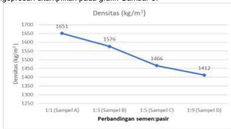
Gambar 9. Densitas masing-masing sampel uji.
