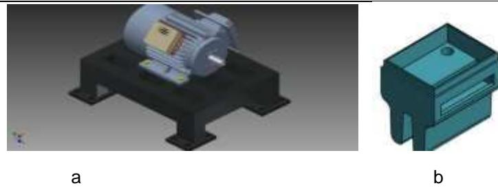
Gambar 2. A. Penempatan NodeMCU ESP8266 dan sensor pada motor, b. holder.
