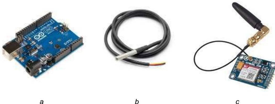
**Gambar 1.** a. Arduino Uno; b. sensor DS18B20; c. Modul SIM 800L.
